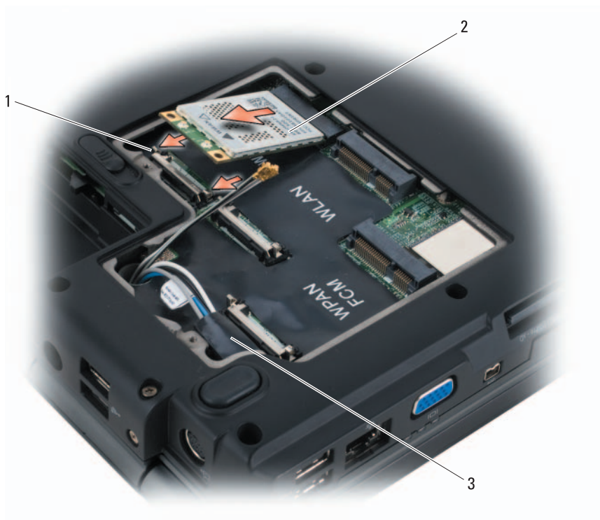
1 לשוניות אבטחה ממתכת (2) כרטיס WWAN 2 כרטיס WWAN 3 שרוול פלסטי (Mylar)
